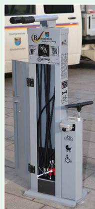
Radservice-Station von Mitarbeitern des Wirtschaftshofes aufgestellt. Diese enthält alles nötige Zubehör für die Reparatur bei einer Fahrradpanne wie unterschiedliche Schrauben-, Imbuß- und Maulschlüssel, Schraubenzieher sowie einen Reifenheber, eine Pumpe mit Adapter für alle Ventile und ist mit einem Caddie-Türschloss-System ausgestattet. Zudem wird demnächst noch ein Schlauchautomat aufgestellt.
